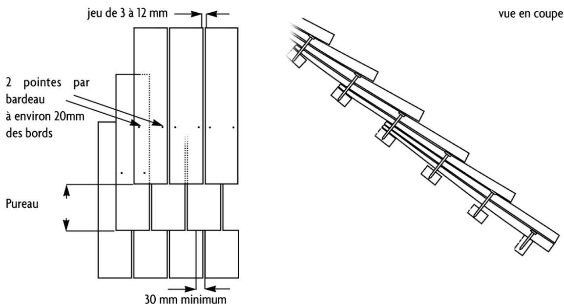
Schéma de disposition des bardeaux
